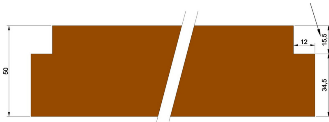
Rozmer drážky pre 5 mm tesnenie dverí
