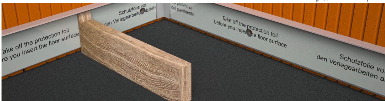
Montáž po zhotovení poteru.
